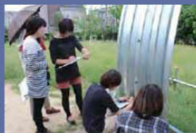
屋根材の表面温度測定
