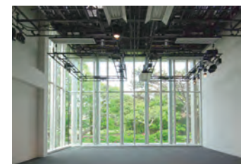
■種々の照明器具を取りつけられる昇降式天井、トップライトなどを備えた「光環境実験室」
