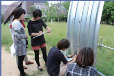
屋根材の表面温度測定
